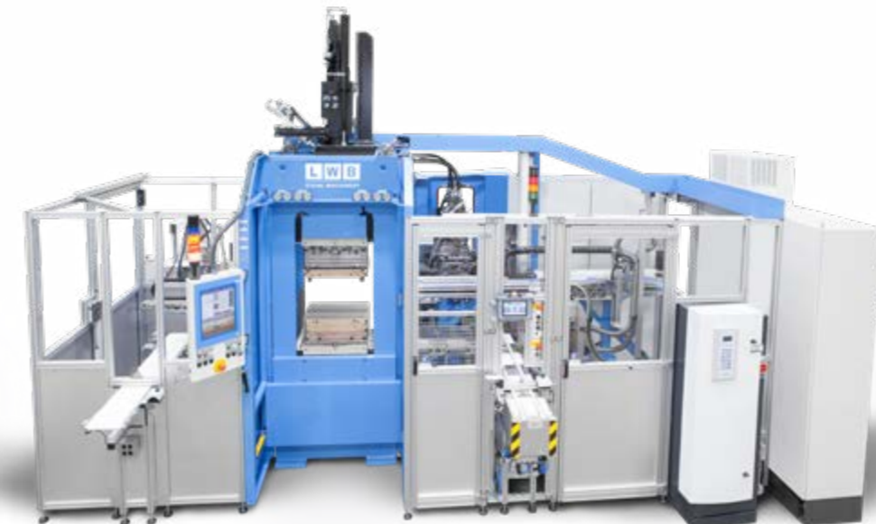
+ VOLLAUTOMATISCHE FERTIGUNGSZELLE ZUR HERSTELLUNG VON BRENNSTOFFZELLENDICHTUNGEN Zur vollautomatischen Herstellung von Platinen aus einer Silikon-Metall-Verbindung. Das Konzept basiert auf einer Rahmenmaschine mit Flüssigsilikon-Spritzeinheit sowie Handlings-Einheiten und Silikonförder-einrichtung. Eine erste Handlings-Einheit übernimmt die Positionierung für die erforderliche Vorbehandlung der Metall-Platinen, sowie das Bestücken der Spritzgießform; die zweite Handlings-Einheit übernimmt die Entnahme aus der Spritzgießform sowie den Abtransport der Platinen.
