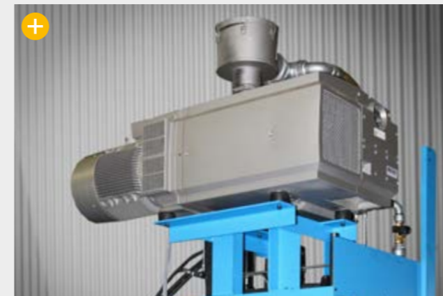
Vakuumpumpe an der Maschine
