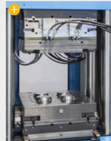
Kaltkanaltechnik in Kombination mit EFE-Spritztechnologie
