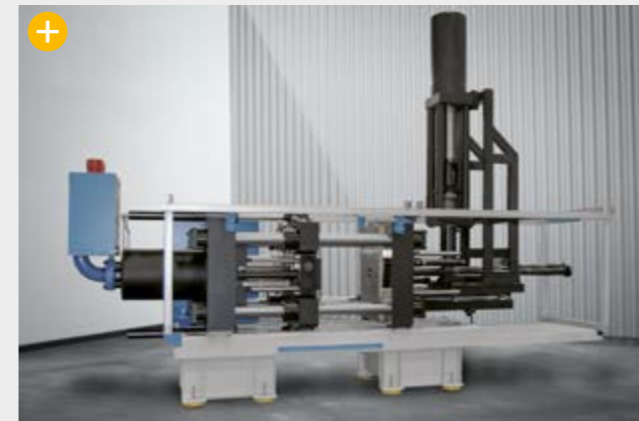
HS-Maschinengestell mit EFE-Spritztechnologie zur Heizeitreduzierung
