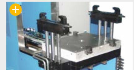
Schnellspannsystem an Trenner und Heizplatte
