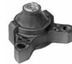
Motorlager Naturkautschuk 60° Shore
