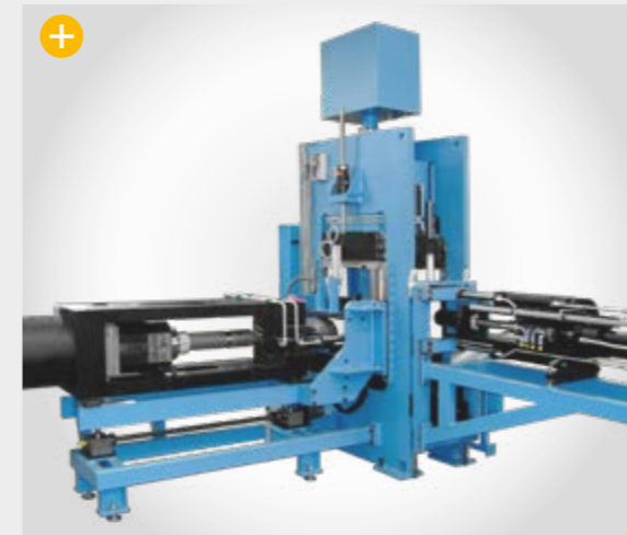
Von oben schließendes Rahmengestell mit zwei horizontal angeordneten Spritzaggregaten
