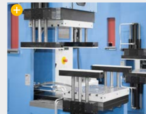
Entformung mit Schiebetisch und Trenner
