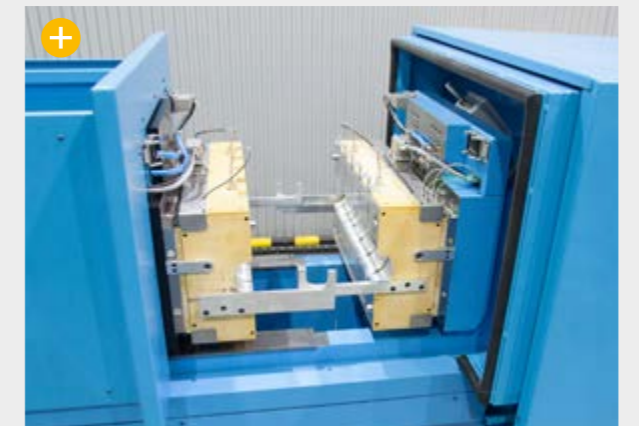
Horizontale C-Rahmenmaschine zur Fertigung von Isolatoren aus Flüssigsilikon
