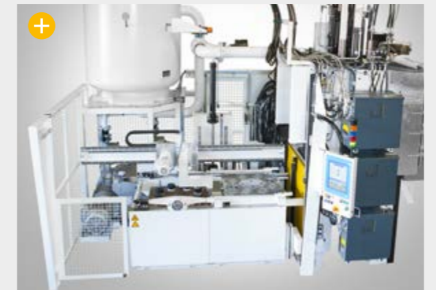
Integration einer kompletten Entformstation
