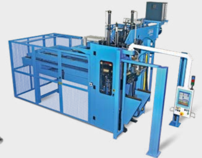
+ DÄMPFUNGS- UND MONTAGEELEMENT Für die Solarindustrie in vollautomatischer Produktion. Eine spezielle Greifer- und Wechselplattentechnik ermöglicht die Produktion von ca. 100 Teilen pro Zyklus.
